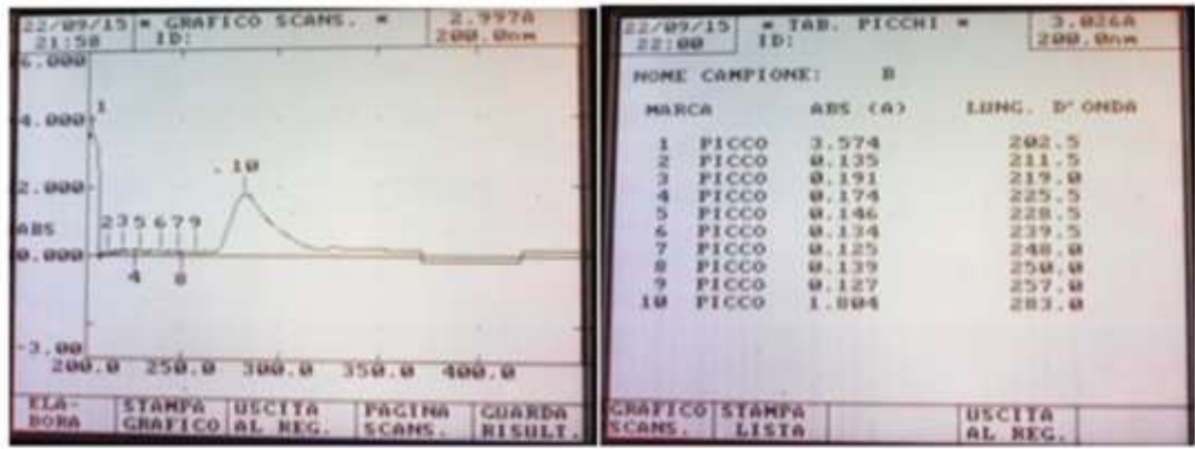
Fig. 53: artemisinina 10 mg in 31,5 ml derivatizzata con metodo1, spettro e altezza picchi
